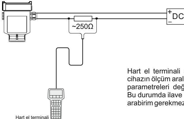
Hart el terminali sayesinde cihazın ölçüm aralığı ve bazı parametreleri değiştirilebilir. Bu durumda ilave yazılım ve arabirim gerekmeyez.
